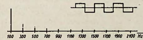
Abb. 13. Fourierzerlegung einer Rechteckschwingung
